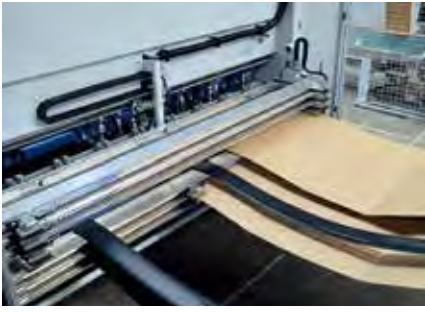
在橡胶辊上运行刀具，降低切阻力和磨损，同时保证高品质切割质量和较长的刀具寿命。
