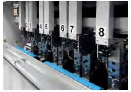
通过完全自动移动和快速重新定位的刀具，可以产生任何种类的纸盒空白。
